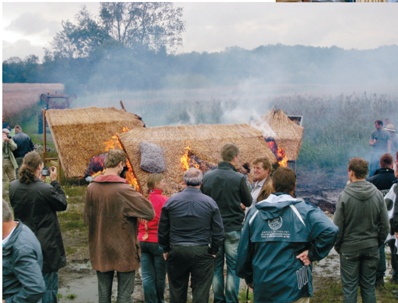
Afbrænding af små tagstykker med forskellige former for brandsikring
